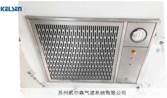
高效过滤器是高效排风口的一个非常重要组成部分,他可以保证通过排风口的空气净化后的质量和洁净度,高效过滤器的选用需要谨慎,根据《综合医院建筑设计规范□GB51039□□传染病医院建筑设计规范□GB50849□□传染病医院建筑施工及验收规范□GB50686等国家现行有关标准、规范的相关规定,排风口采用的高效过滤器的效率应不低于现行国家标准《高效空气过滤器□GB/T13554的B类。并且,高效过滤器的密封方式也要特别注意,苏州凯尔森建议选择液槽密封型的高效过滤器,以便确保过滤器安装时的密封性达到零泄漏。苏州凯尔森建议您从正规厂家购买高效过滤器,以确保净化效率。
