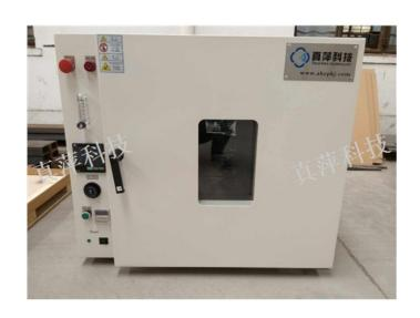
1. 保温材料:采用正厂玻璃纤维公司出品的100K级高密度保温板填充,有效的防止了热能浪费。2. 电热部分:采用进口覆套式电热器 [SHEATHEDHEATER] 无尘无氧化电热发生器5风道部分:整体结构采用了水平送风的方式由左向右送风后经美国进口H.E.P.A [(特殊风道设计)过滤效果可达99.99%, Class 100 [] 可靠先进的测控系统1温度控制装置:日本进口温控器,内置PID自动整定,斜率设定功能2温度控制方式为SSR固态继电器功率调整输出,温度采集探头为特制铠装 K型热电偶3温度监控装置:采用日本六通道巡回检测有纸记录仪,可将烤箱内实时环境温度进行检测打印。合肥真萍工业烤箱的运用领域!淮北做工业烤箱
